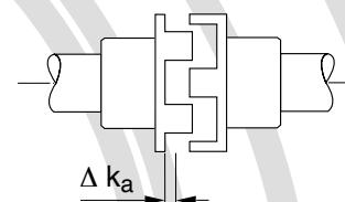
Il compense efficacement les désalignements angulaires, radiaux ou axiaux à l'intérieur d'une plage de tolérances pré définie.
