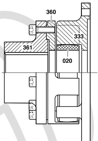
**SX-BT** mit Bremstrommel für Turbokupplungen
