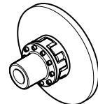
Kupplung mit Flanschnaben, aushebbaren Klauenringen, Zwischenring und Brems-Vollscheibe.
